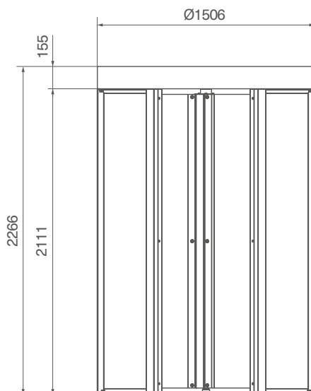
\*Embora a altura do equipamento seja de 2266mm, a altura mínima necessária para instalação é de 2600mm.
